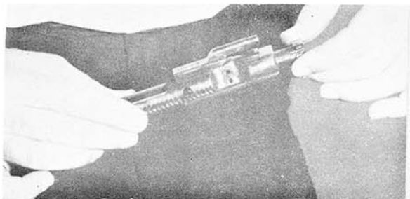
Step 9. Remove Bolt.
